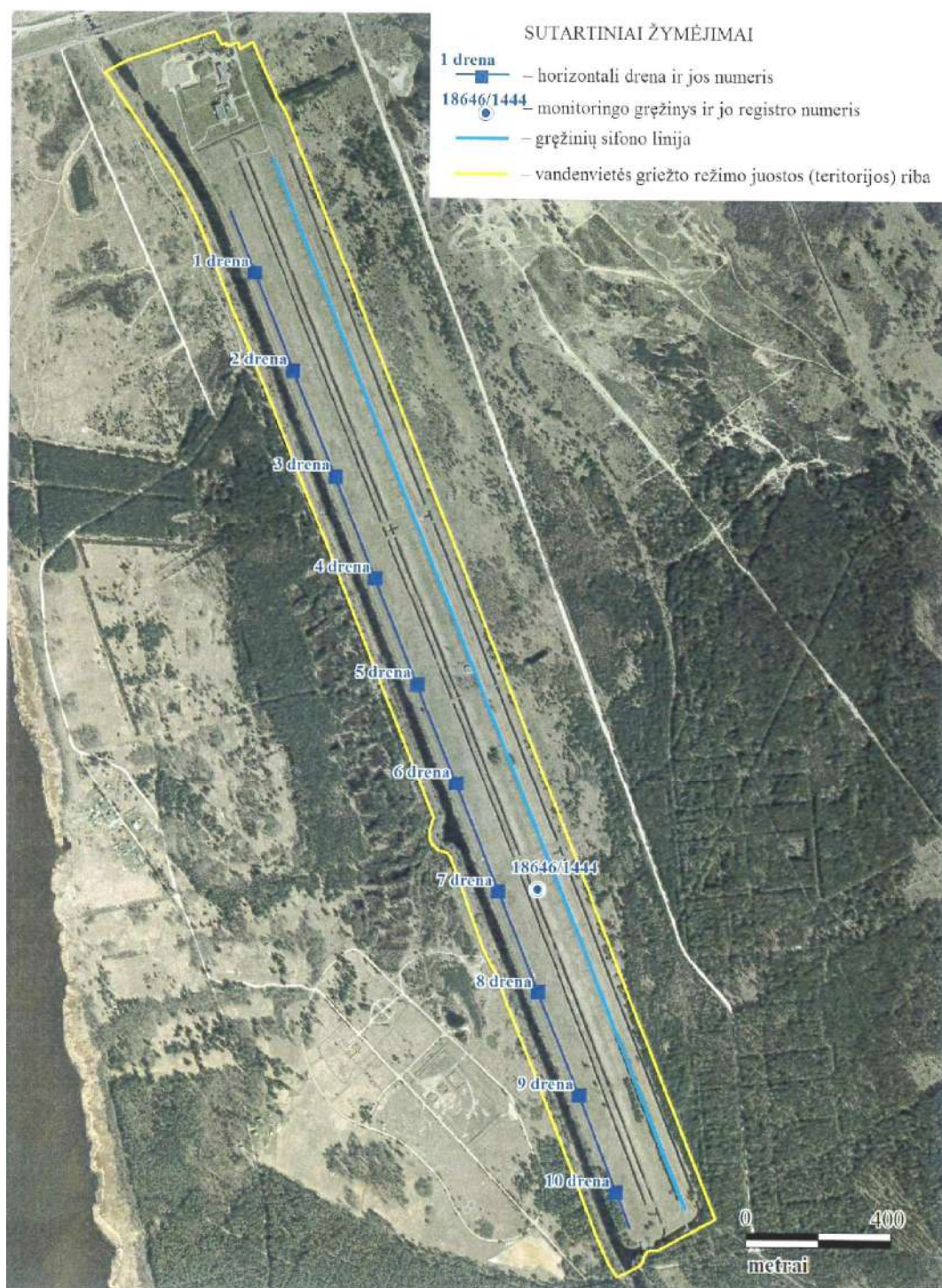
7 pav. Klaipėdos III vandenvietės schema (pagal UAB "Grotą", [7])
